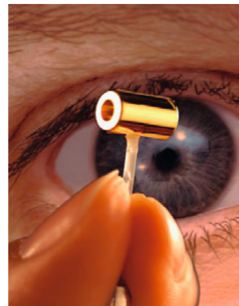
Inerciální udržení – dutina zvaná hohlraum pro experiment s nepřímo zapalovanou fúzí
