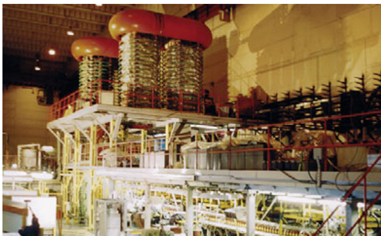
I to je magnetické udržení – magnetická past GOL-3-II v pozadí s generátorem elektronového svazku U2 v novosibirském Budkerově Ústavu jaderné fyziky.
