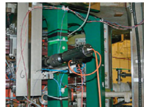
Rychlá CMOS kamera připojená tangenciální přírubou COMPASSu (příruba v toroidálním směru, tj. podél plazmatu)
