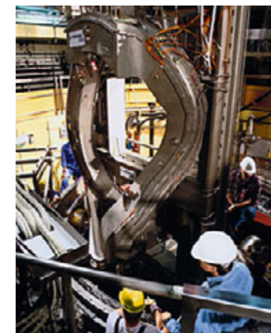
Komora největšího tokamaku na světě JET v anglickém Culhamu • vlevo Test třídímenzionálního prototypu supravodivé cívky pro stellarátor W7-X ve Forschungszentrum v Karlsruhe. Na obrázku je cívka před zapojením vsunována do kryostatu, ve kterém se ochladí na -269 °C. • vpravo
