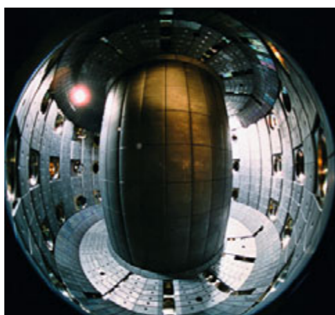
Vakuová komora švýcarského tokamaku TCV
