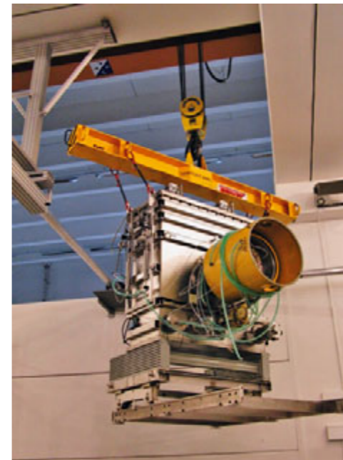
Jeden ze dvou generátorů svazků vysokoenergetických atomů (NBI) na cestě k tokamaku COMPASS
