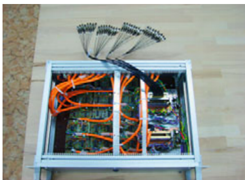
Dvoustupňový zesilovač integrovaný s řádkovou kamerou a koncovkou optických vláken
