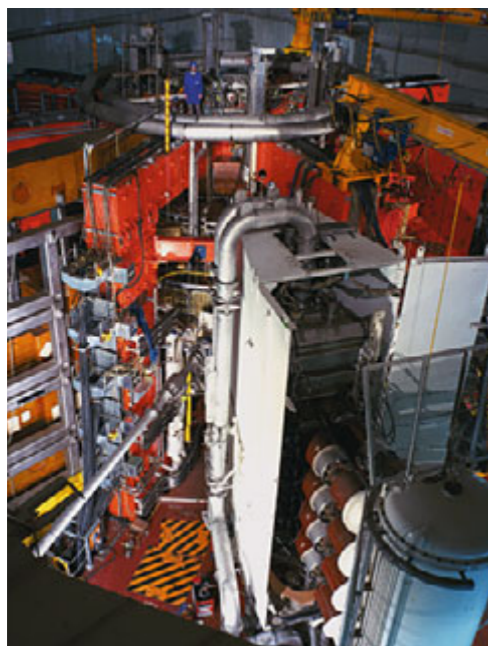
Tokamak JET, vpředu zdroj neutrálních svazků pro ohřev plazmatu
