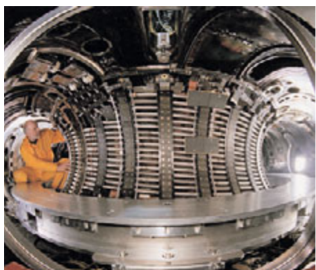
Limitér vymezující průměr plazmatu chrání před teplem stěny komory a patří tak k nejvíce tepelně namáhaným částem tokamaku. Toroidální variantu poprvé vyzkoušel francouzský Tore Supra. Limitér na snímku patří německému tokamaku TEXTOR v Jülichu.
