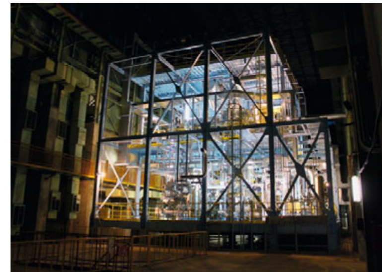
Schéma kryogenního systému pro ITER ● nahoře Zkušební lithiová smyčka pro urychlovač neutronů, který bude používat IFMIF – Mezinárodní fúzní zařízení pro ozařování materiálů neutrony. ● dole
