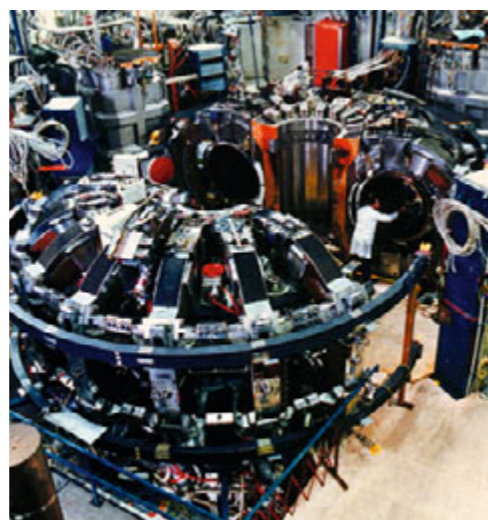
Německý tokamak TEXTOR v Jülichu slouží ke studiu vzájemného působení plazmatu a stěn komory.
