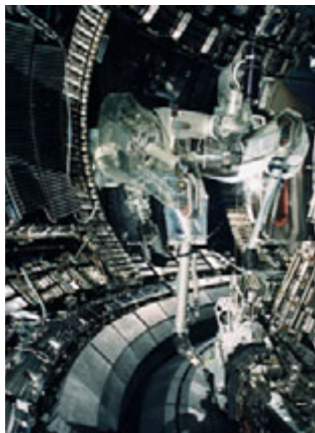
Unikátní dálkově ovládaná „paže“ umožňuje práci v komoře tokamaku JET i po „termojaderné“ kampani, která vyvolá sekundární radioaktivitu vnitřních stěn komory.
