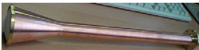
Mikrovlnná anténa radiometru • nahoře 16kanálový přijímač radiometru • dole
