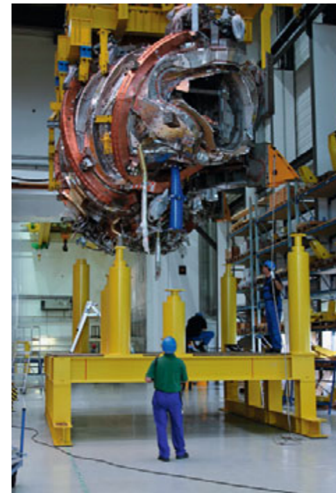
Stelarátor Wendelstein W7-X má 20 planárních a 50 třídímenzionálních cívek.
