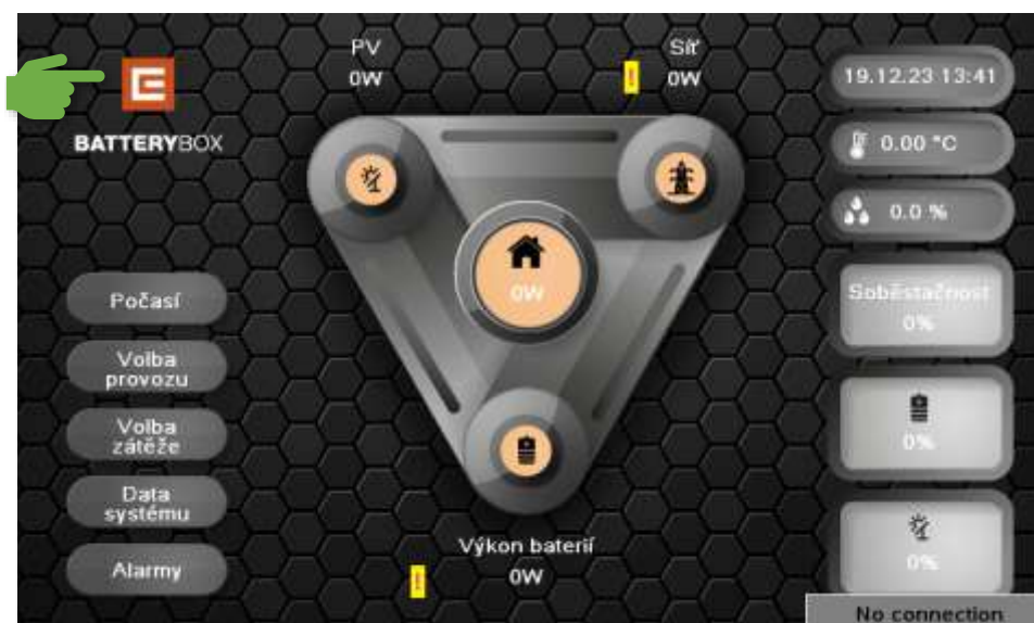
Obr. 40 – základní obrazovka na LCD displeji systému CES BATTERY BOX
